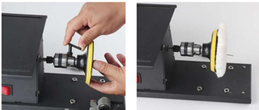
1. Отвинтите сверлильный патрон с помощью гаечного ключа. Вкрутите шлифовальный диск и затяните его с помощью ключа.
