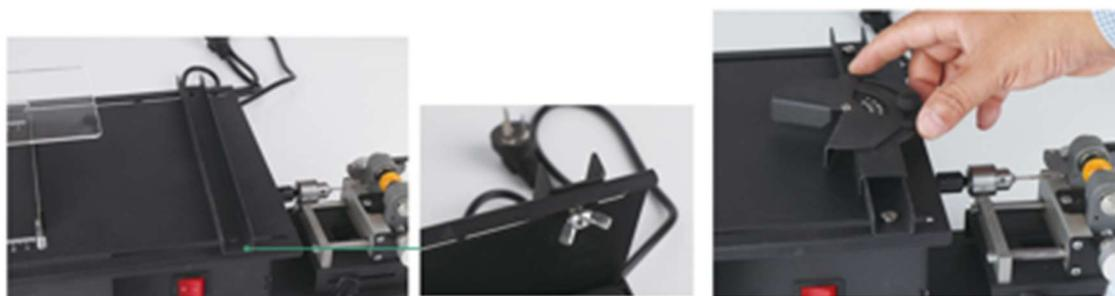
1. С помощью болта и вкручивающегося фиксатора установите подставку с данной принадлежностью
